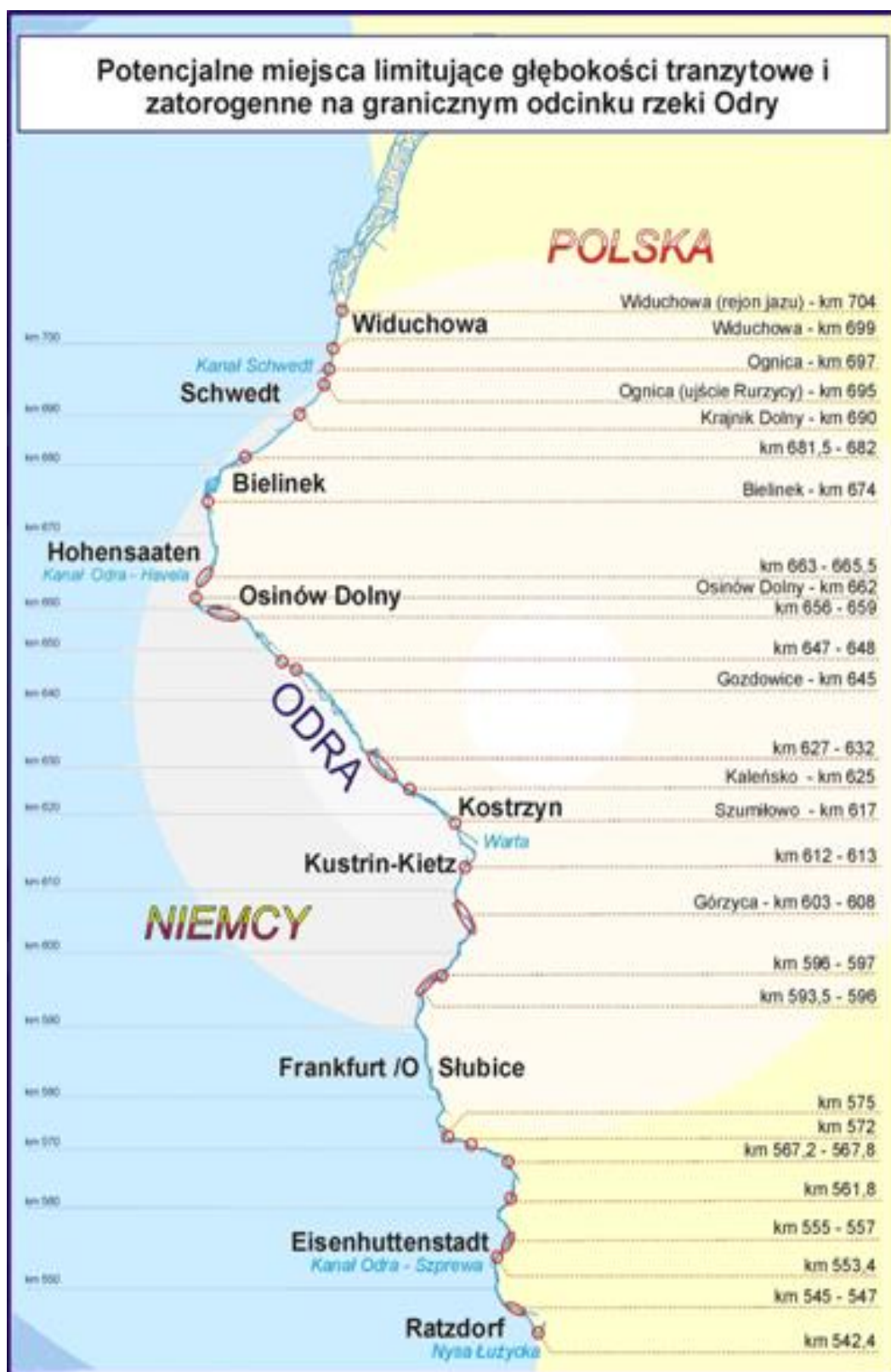
Rysunek 22. Źródło RZGW Szczecin. Potencjalne miejsca limitujące głębokości tranzytowe i zatorogenne na granicznym odcinku rz. Odry
